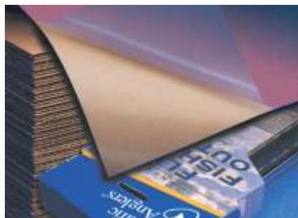
Diseñada específicamente para impresión flexográfica en planchas para corrugados. La cinta de montaje flexográfico delgada 3M™ 2205 es una cinta doble faz de película de poliéster de 5 mils con adhesivo cortado en cruz. El corte en cruz reduce el atrapamiento de aire, ahorrando tiempo y mejorando la calidad de impresión.
