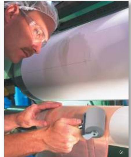
**3M™ Hand Roller 903** – Para montajes libres de aire, ayudando a salir el mismo a través de los micro canales en las cintas de montaje 3M™ para planchas flexográficas.
